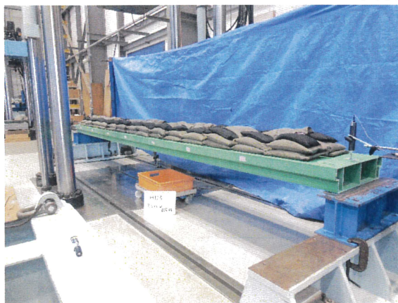
写真5 試験体状況 載荷荷重 3.5kN/m 2 時 ・蓋のたわみ
