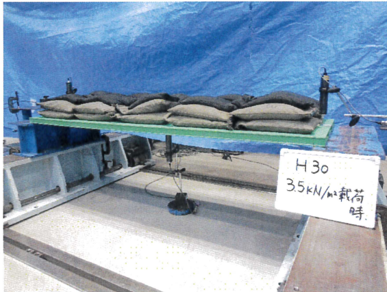
写真1 試験体状況 載荷荷重 3.5kN/m 2 時 ・蓋のたわみ
